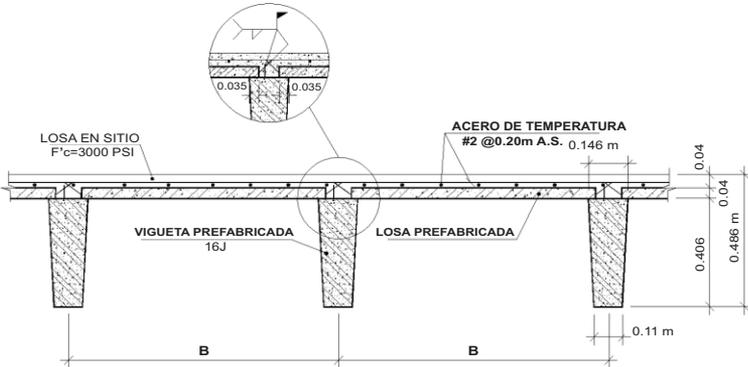
**SISTEMA DE VIGUETA 16J + LOSETA PREFABRICADA**
