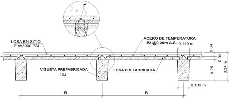
**SISTEMA DE VIGUETA 10J + LOSETA PREFABRICADA**
