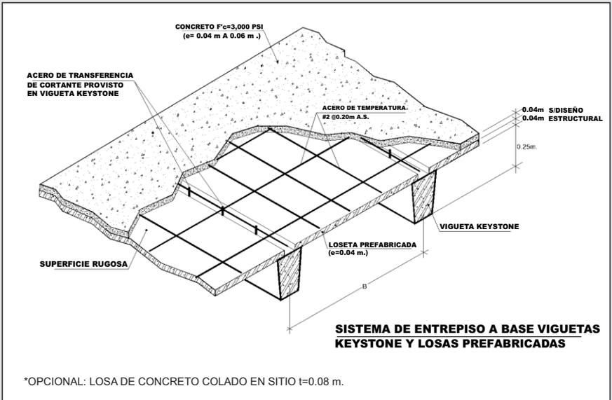
Este sistema prefabricado de entrepiso está compuesto por viguetas tipo Keystone pretensadas, losa de concreto prefabricada y losa colada en sitio, creando así una losa nervada compuesta unidireccional.
